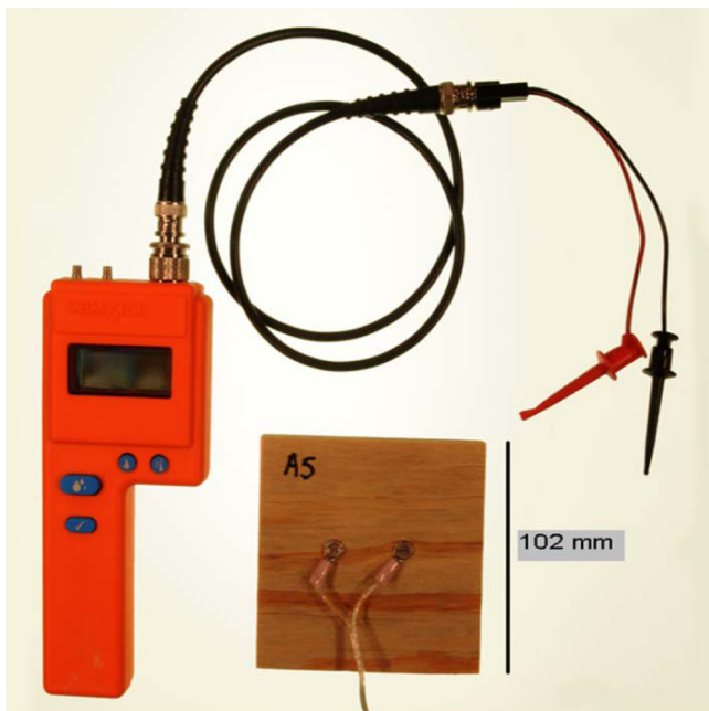
FIG. 1—Moisture meter and specimen.
